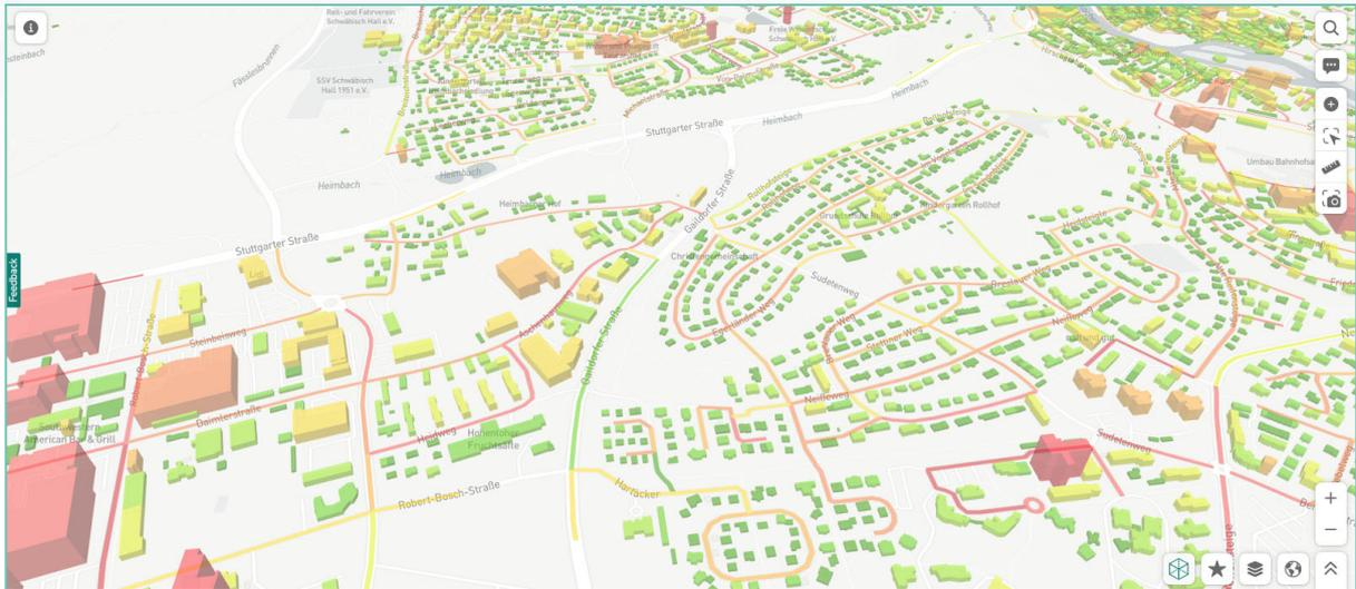
Darstellung des Wärmebedarfs in einem 3D-Modell der Stadt mit Skalierung der Gebäudehöhe in Abhängigkeit des Verbrauchs (eigene Erhebungen und Berechnungen greenventory).
