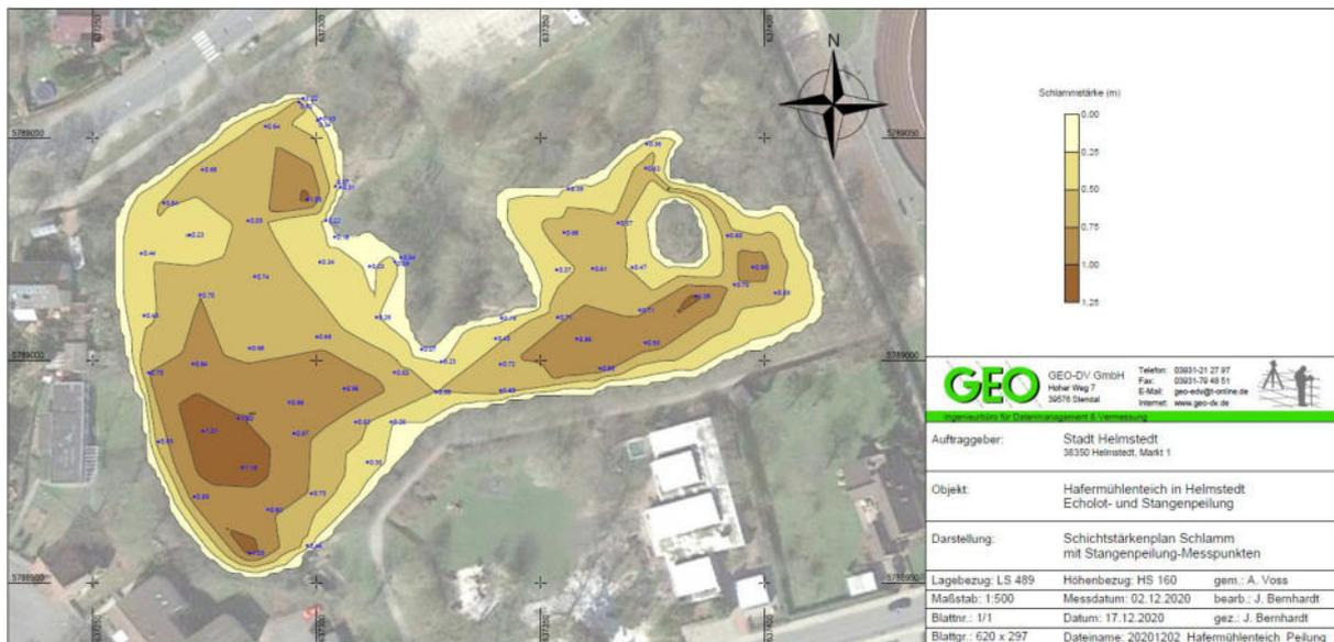
Abbildung 26 Schlammstärkenmessung Hafermühlenteich
